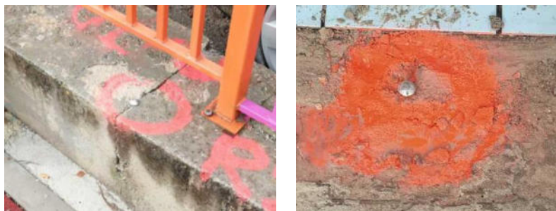
Слика 2.1 Стабилизован репер основне мреже (лево) и мреже објекта (десно)
