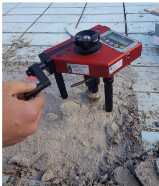
Слика 3 – Диспозиција испитивања адхезије Pull-off методом
