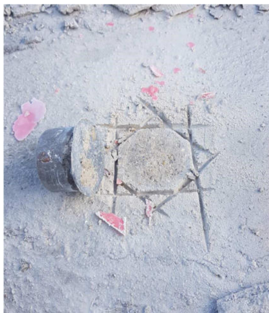
Слика 3 – Диспозиција испитивања адхезије Pull-off методом
