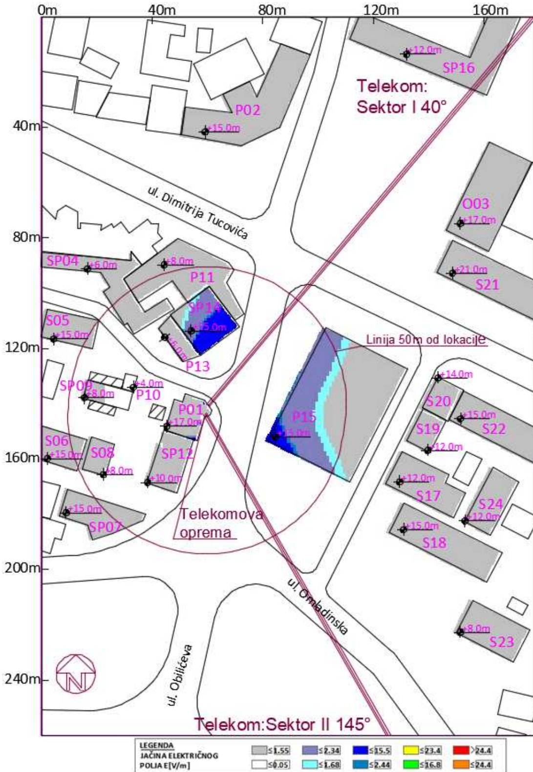
Slika 6.4 Rezultati proračuna jačine električnog polja u objektima na najizloženijim spratovima za slučaj rada sistema LTE800 operatora Telekom Srbija
