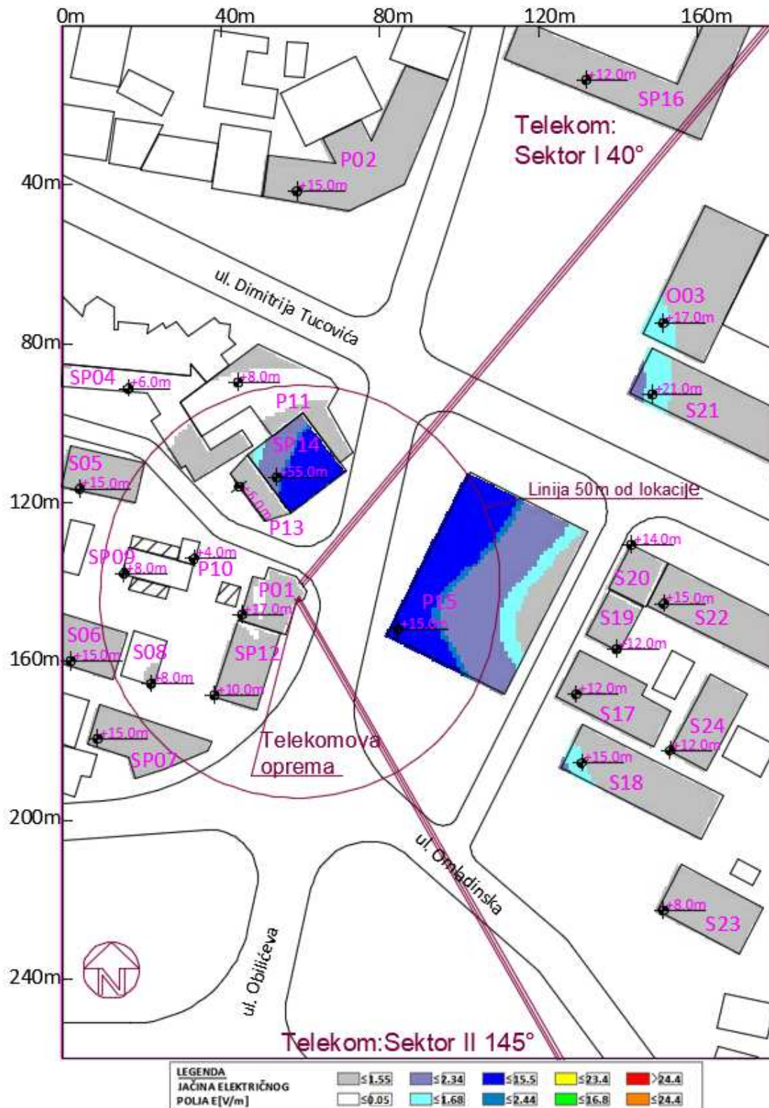
Slika 6.3 Rezultati proračuna jačine električnog polja u objektima na najizloženijim spratovima za slučaj rada sistema LTE1800 operatora Telekom Srbija
