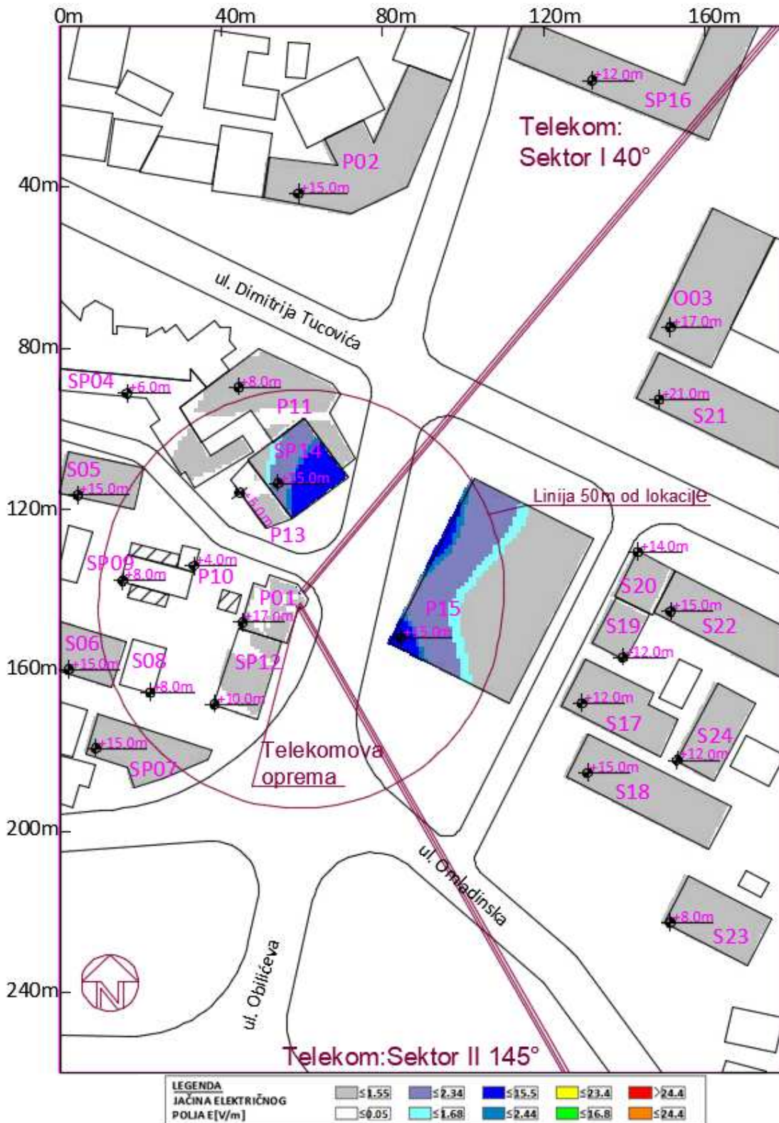
Slika 6.5 Rezultati proračuna jačine električnog polja u objektima na najizloženijim spratovima za slučaj rada sistema LTE2100 operatora Telekom Srbija
