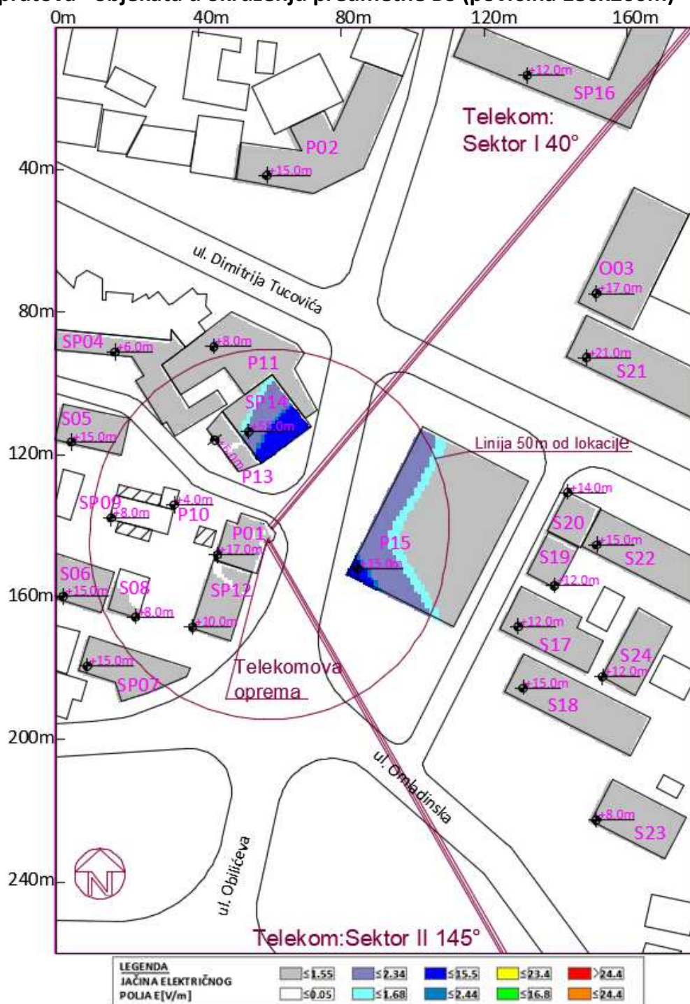
Slika 6.1 Rezultati proračuna jačine električnog polja u objektima na najizloženijim spratovima za slučaj rada sistema GSM900 operatora Telekom Srbija
