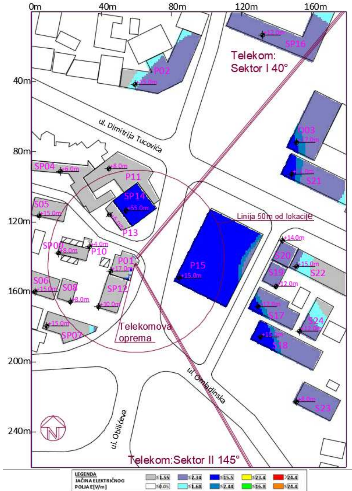
Slika 6.6 Rezultati proračuna jačine električnog polja u objektima na najizloženijim spratovima za slučaj rada sistema GSM900/UMTS2100/LTE1800/LTE800/LTE2100 operatora Telekom Srbija
