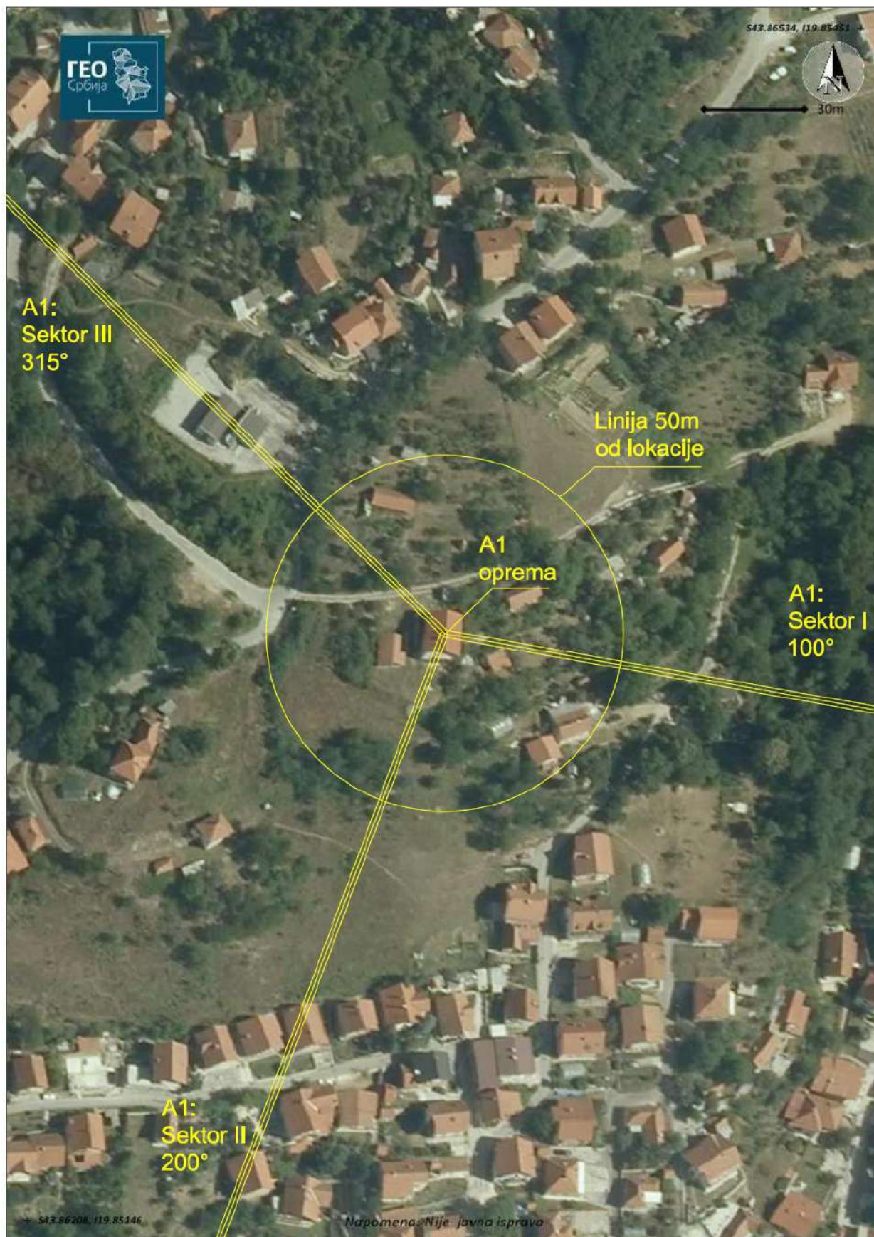
Slika 5.1 Dijagram zračenja radio bazne stanice "KG3521_01 UE_Uzice_Carina"
