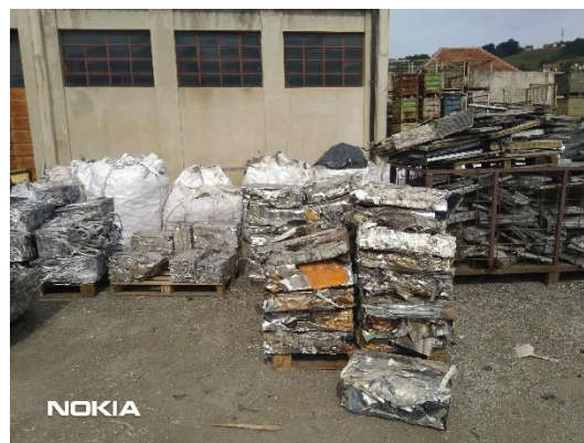
Слика 9. Издвојене пресоване секундарнесировине
