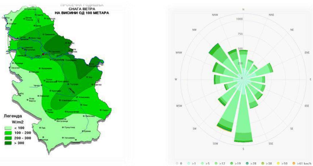
**Слика бр.5:** Просечна годишња снага ветра на висини од 100m
